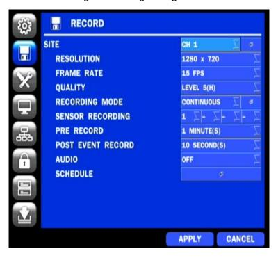
Figure 4.3.1. RECORD Setup Screen
