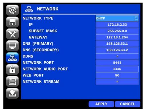
Figure 4.6.1. NETWORK Setup Screen
