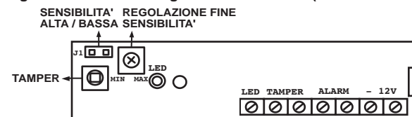
Figura 1B: Schema collegamento morsettiera (RK600SMXX00A)
